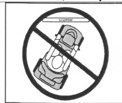
Figur 4. Forkert tilgang til kantsten
