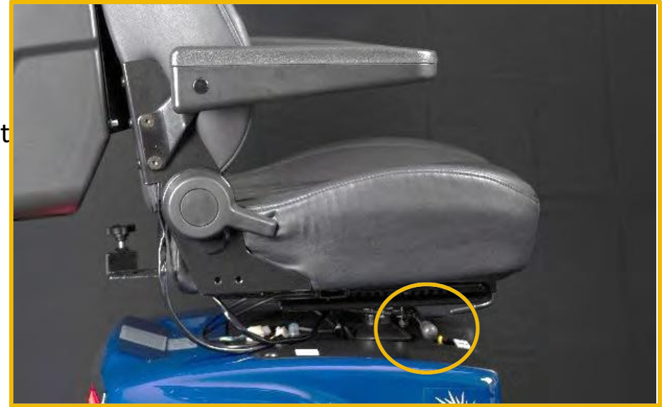
Figur 5 – Træk i det sorte håndtag for at justere ryglænet
