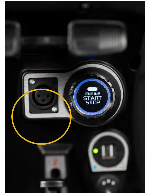
Kuva 19 – Ohjaustankoon asennettu latausportti
