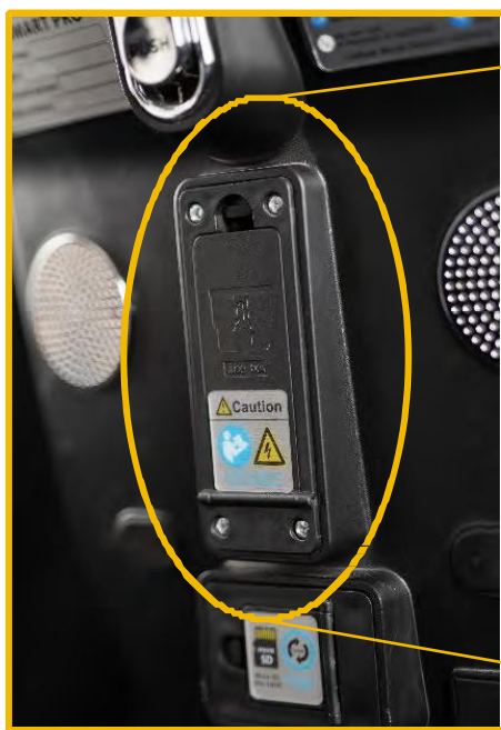
Figur 21 – Plassering av sikringsboksen
