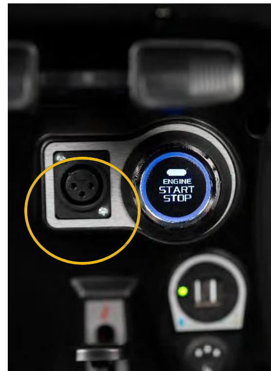
Figur 19 – Laddningsport monterad på styret
